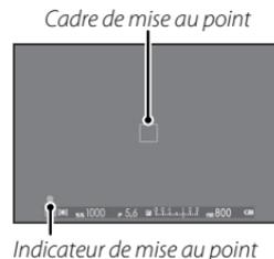
**Si l'appareil photo ne parvient pas à faire la mise au point**, le cadre de mise au point devient rouge, le symbole **!AF** apparaît et l'indicateur de mise au point clignote en blanc.
