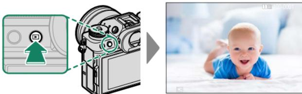
Ulteriori immagini possono essere visualizzate premendo il selettore verso sinistra o verso destra o ruotando la ghiera di comando anteriore. Premere il selettore o ruotare la ghiera verso destra per visualizzare le immagini nell'ordine di registrazione, verso sinistra per visualizzarle in ordine inverso. Tenere premuto il selettore per scorrere rapidamente fino alla foto desiderata.
