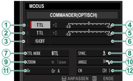
Die drahtlose optische Blitzfernsteuerung von Fujifilm bietet die Auswahl aus vier Kanälen (Kanäle 1 bis 4) für den Austausch der optischen Signale zwischen dem Master und den Slave-Blitzgeräten. Unterschiedliche Kanäle lassen sich für verschiedene Gerätekonfigurationen nutzen, oder um gegenseitige Störungen zu verhindern, wenn mehrere Systeme in räumlicher Nähe betrieben werden.
