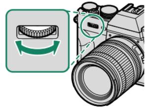
Die Einstellung der Blende kann mit **TASTEN/RAD-EINSTELLUNG** > **BEDIENRAD-EINST.** wieder dem hinteren Einstellrad zugewiesen werden.
