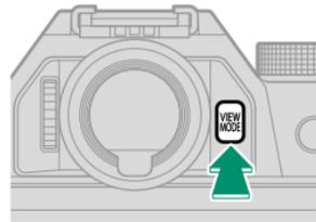
Verwenden Sie **DISPLAY-EINSTELLUNG > VIEW MODE-EINSTELLUNG** im Hauptmenü, um einen Anzeigemodus für den EVF und den LCD-Monitor auszuwählen.
