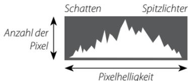
**Optimale Belichtung:** Die Pixel sind auf einer gleichmäßigen Kurve über den gesamten Tonwertbereich verteilt.
