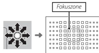
Um die Anzahl der Fokusbereiche in der Zone auszuwählen, drehen Sie das hintere Einstellrad. Drehen Sie das Einstellrad nach rechts, um durch die Zonengrößen zu wechseln in der Reihenfolge  $3 \times 3$ ,  $5 \times 5$ ,  $7 \times 7$ ,  $3 \times 3 \dots$ , links, um durch die Zonengrößen in umgekehrter Reihenfolge zu wechseln, oder drücken Sie auf die Mitte des Wählrads, um eine Zonengröße von  $3 \times 3$  auszuwählen. Drücken Sie **MENU/OK**, damit die Einstellung wirksam wird.
