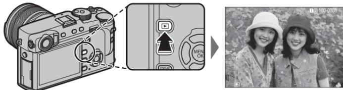
Drücken Sie die Auswahltaste nach links oder rechts oder drehen Sie das vordere Einstellrad, um weitere Bilder anzuzeigen. Durch Drücken der Auswahltaste oder Drehen des Einstellrads nach rechts werden die Bilder in der Aufnahmereihenfolge angezeigt, durch Drücken bzw. Drehen nach links in umgekehrter Reihenfolge. Halten Sie die Auswahltaste gedrückt, um schnell zum gewünschten Bild zu blättern.
