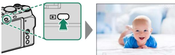
向左或向右按下对焦棒（对焦杆）或者旋转前指令拨盘可查看其他照片。向右按下对焦棒或向右旋转拨盘可按拍摄顺序查看照片，向左按下或向左旋转则按相反顺序查看照片。按住对焦棒可快速滚动至您所需的照片。
