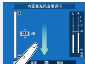
• 默认设定下，触摸功能动作被禁用。若要启用触摸功能动作，请将
