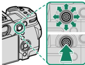
Para seleccionar el papel desempeñado por el mando de enfoque, mantenga pulsado el centro del mando o utilice **■ AJUSTE DE BOTÓN/DIAL > AJUSTE DE LA PALANCA DE ENFOQUE**.
