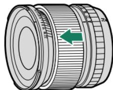
Per la messa a fuoco manuale, far scorrere la ghiera messa a fuoco verso la parte posteriore e ruotarla mentre si controllano i risultati nel display della fotocamera. La distanza di messa a fuoco e gli indicatori della profondità di campo possono essere usati per assistere la messa a fuoco manuale.
