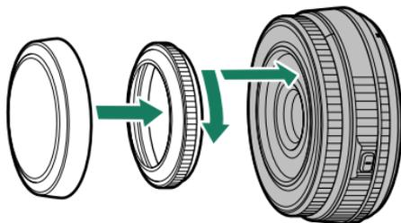
**!** Se si monta il cappuccio troppo strettamente dopo aver montato un filtro sull'obiettivo, il filtro potrebbe rimanere incastrato nel cappuccio quando questo viene rimosso. **Non tentare di separare con forza il cappuccio e il filtro, poiché le filettature del filtro potrebbero ferire le mani.** Coprire sia il cappuccio che il filtro con degli apri barattolo in silicone o simili e svitarli utilizzando il palmo delle mani.
