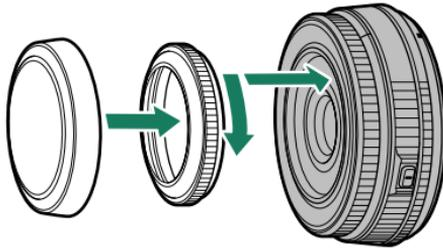
⚠ Wenn Sie die Abdeckung zu fest anbringen, nachdem Sie einen Filter am Objektiv angebracht haben, kann der Filter an der Abdeckung hängen bleiben, wenn diese abgenommen wird. **Versuchen Sie nicht, Abdeckung und Filter gewaltsam zu trennen, da Sie sich dabei Ihre Hände am Filtergewinde verletzen könnten.** Tragen Sie Silikon-Schraubdeckelöffner oder Ähnliches auf Abdeckung und Filter auf und schrauben Sie diese dann mit den Handflächen auseinander.
