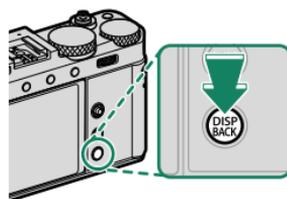
Die Anzeigen für den EVF-Sucher und den LCD-Monitor werden separat ausgewählt. Um die EVF-Anzeige zu wählen, müssen Sie während der Benutzung der **DISP/BACK**-Taste den Sucher ans Auge nehmen.
