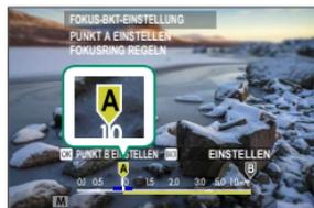
Der gleiche Fokusbereich kann ausgewählt werden, indem Sie auf das am weitesten entfernte Ende des Motivs scharf stellen.
