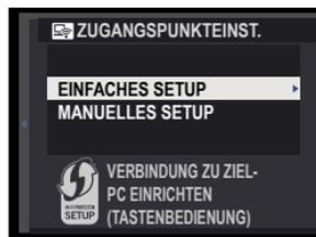
📌 Um einen WLAN-Router auszuwählen oder die SSID des Routers manuell einzugeben, wählen Sie **MANUELLES SETUP** aus.
