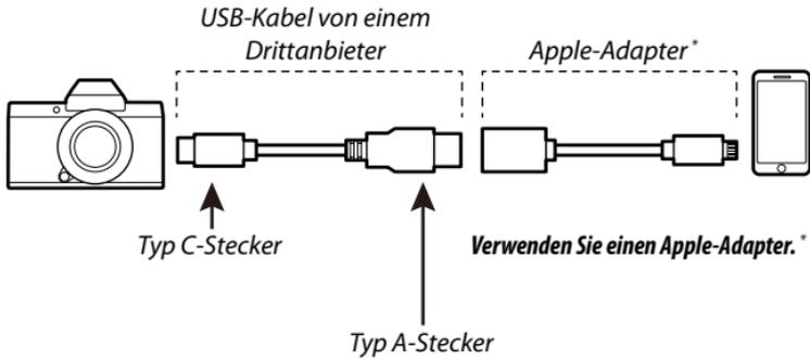
\* Verwenden Sie einen Apple Lightning-auf-USB-Kamera-Adapter oder Lightning-auf-USB-3-Kamera-Adapter.
