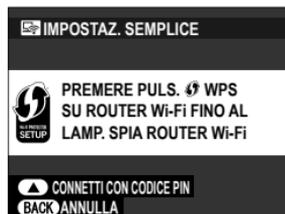
È inoltre presente l'opzione di eseguire la connessione utilizzando un PIN. Visualizzare il PIN della fotocamera premendo la leva di messa a fuoco verso l'alto e inserirlo sul router LAN wireless.
