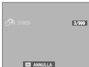
**!** La ripresa a intervalli con timer non può essere utilizzata con tempi di posa di "bulb" (posa B) o con la fotografia di esposizioni multiple. In modalità burst, viene scattata una sola foto a ogni pressione del pulsante di scatto.
