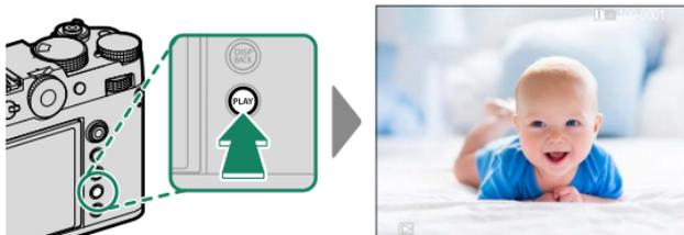
Ulteriori immagini possono essere visualizzate premendo la leva di messa a fuoco verso sinistra o verso destra o ruotando la ghiera di comando anteriore. Premere la leva di messa a fuoco o ruotare la ghiera verso destra per visualizzare le immagini nell'ordine di registrazione, verso sinistra per visualizzarle in ordine inverso. Tenere premuta la leva di messa a fuoco per scorrere rapidamente fino all'immagine desiderata.
