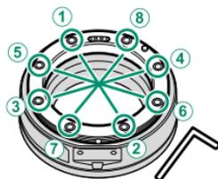
**7** Ziehen Sie die acht Schrauben in der Reihenfolge aus dem Schritt 6 wieder fest.
